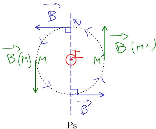
Prenons l'exemple d'un fil rectiligne perpendiculaire à la feuille et parcouru par un courant I.
